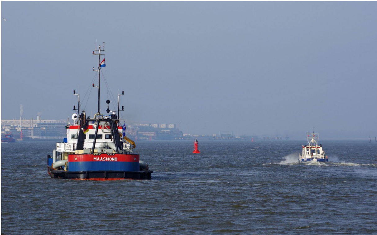
Abb. 3: Das Wasserinjektionsgerät Maasmond beseitigt effizient Sandriffel auf der Unterelbe (Foto: Boris Hochfeld).
