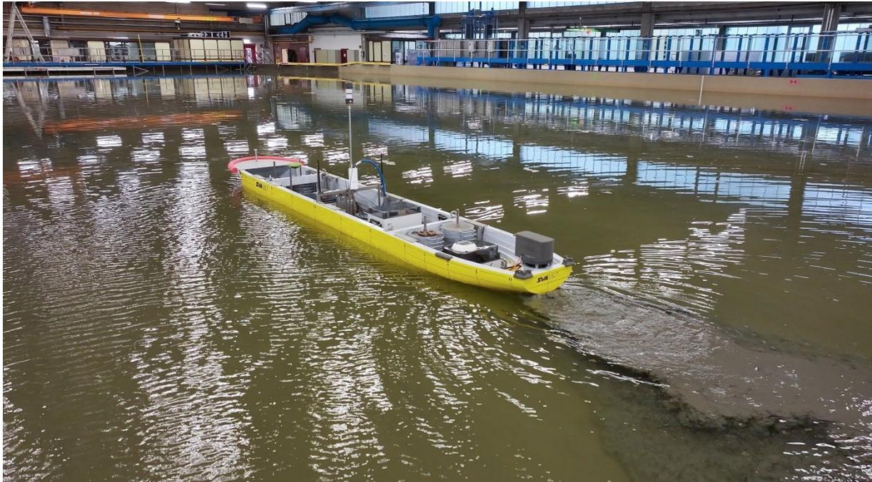
Abb. 2: Zur Reduzierung der Baggermengen wird auch geprüft, inwieweit Schiffe in flüssigem Schlamm noch sicher navigieren können, so wie hier in einem wissenschaftlichen Großversuch in der Bundesanstalt für Wasserbau (BAW) in Rissen. Foto: BAW
