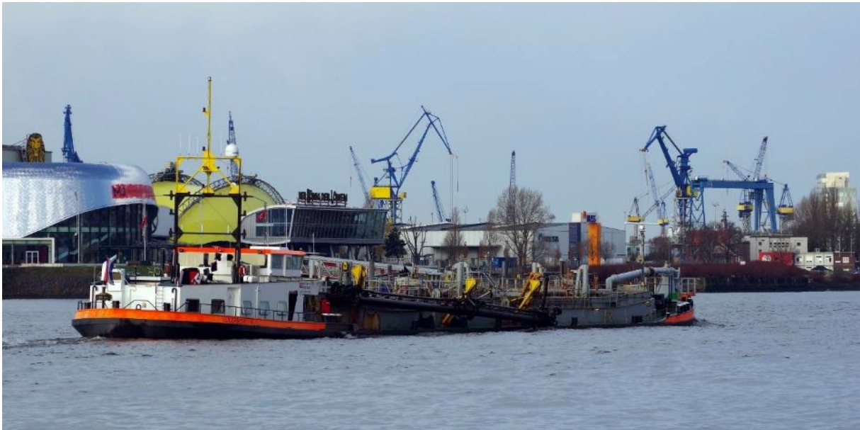
Abb. 3: Der kleine Hopperbagger V.d.Graaf Sr. ist besonders für schmale und enge Hafengebiete geeignet (Foto: Boris Hochfeld).
