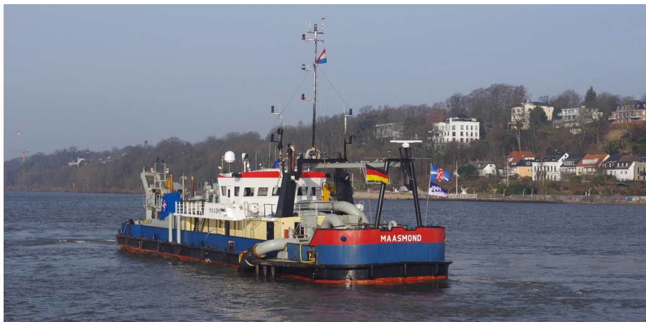
Abbildung 6: Das Wasserinjektionsgerät Maasmond bei der Einebnung von Sandriffeln (Foto: Boris Hochfeld).
